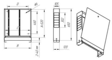
Рис. 1. Шкаф распределительный коллекторный ШРН «Балтика»
